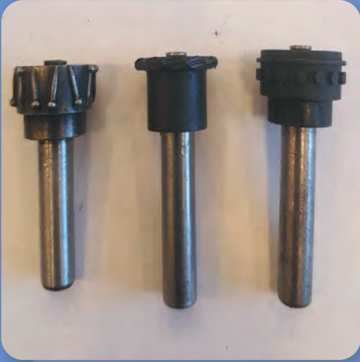
Çark Desen Modelleri Ayakkabı tabanının altına desen ve model verme işlemlerinde kullanılır.
